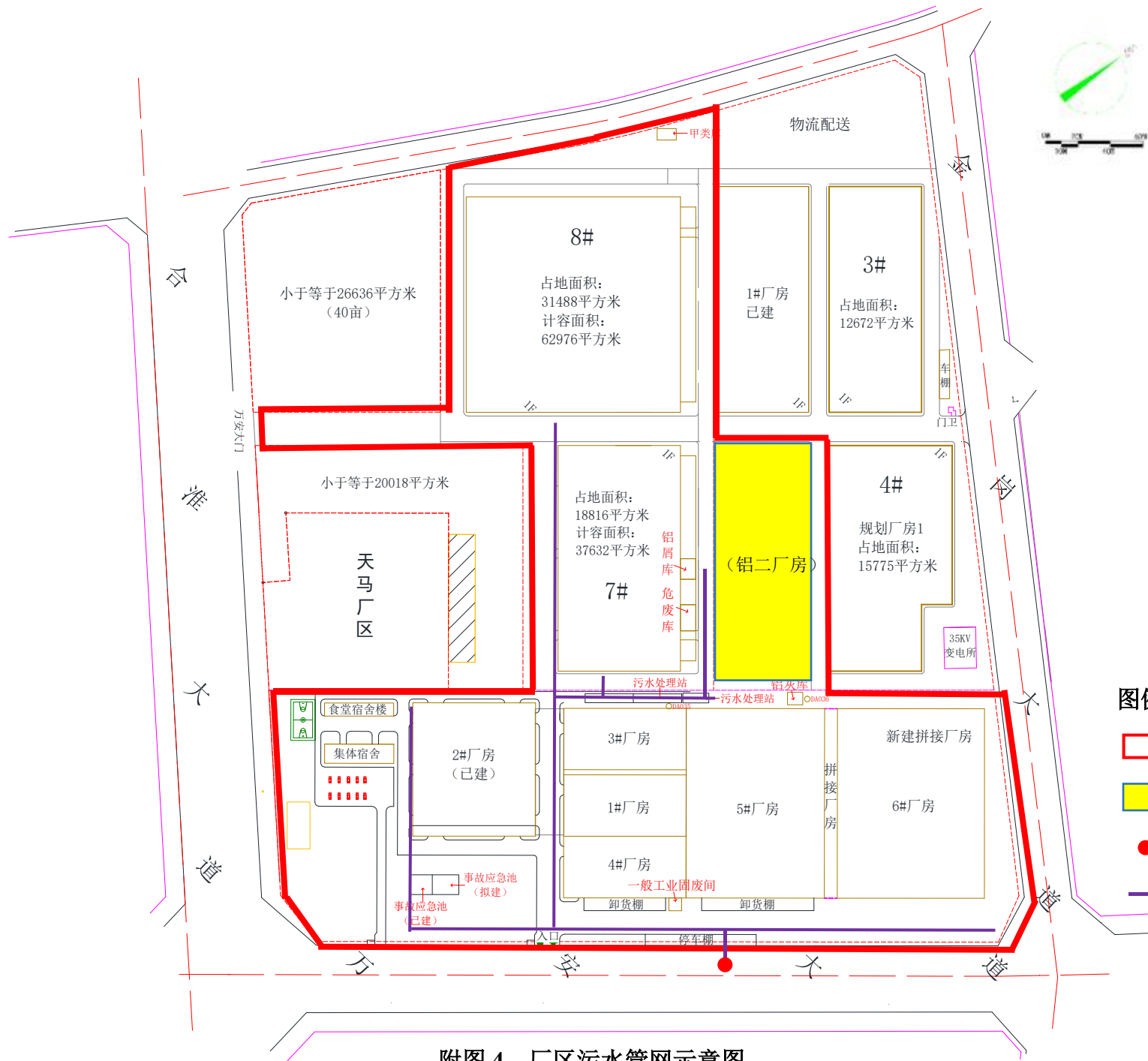
附图 4 厂区污水管网示意图
